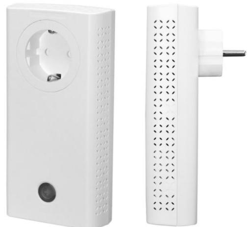
El adaptador Ethernet PowerGrid 9086, compatible con el estándar de red ITU-T G.hn, está diseñado para satisfacer la creciente demanda de conectividad y cobertura perfectas en varios dispositivos conectados simultáneamente en toda la casa. El extensor mediante enchufe a red eléctrica G.hn Powerline Wi-Fi permite a los usuarios llevar Wi-Fi a cualquier lugar de la casa para la transmisión simultánea de Internet / video y el uso de dispositivos IoT.
