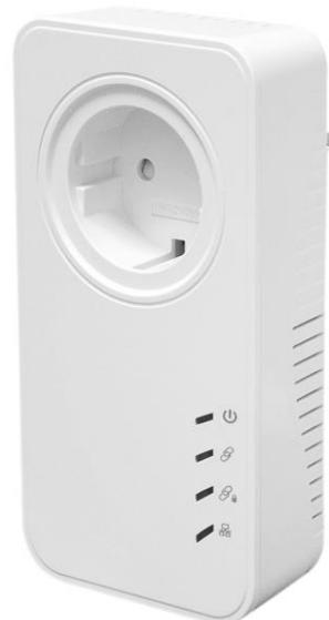
El adaptador Ethernet PowerGrid 9084, compatible con el estándar de red ITU-T G.hn proporciona la mejor calidad de transmisión de datos para una experiencia de "hogar conectado" de alta velocidad. Permite a los usuarios extender una red de área local a través de líneas eléctricas existentes, eliminando la necesidad de cableado adicional. La instalación en casa (o en una oficina pequeña) es rápida y fácil, ya que el PowerGrid 9084 viene con tecnología plug-and-play.
