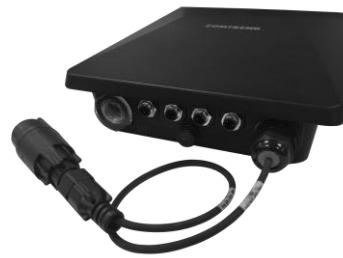
La MDU-4620 es una DPU FTTdp (fibra hasta el punto de distribución) con un diseño híbrido de fibra / coaxial para proporcionar el servicio de banda ancha bajo la red de cable coaxial existente al cliente de televisión por cable.
