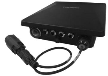
La MDU-4620 es una DPU FTTdp (fibra hasta el punto de distribución) con un diseño híbrido de fibra / coaxial para proporcionar el servicio de banda ancha bajo la red de cable coaxial existente al cliente de televisión por cable.
