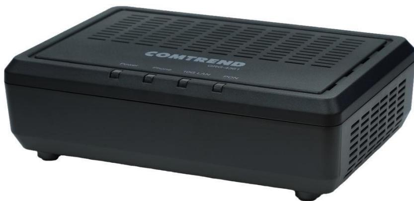
El equipo **GRG-4361** de Comtrend está diseñado como un bridge XGS-PON capaz de proporcionar una conexión a Internet sólida y estable a través de fibra XGS-PON con un puerto Ethernet de 10 Gigabits como LAN para conectar un router neutro Wi-Fi doméstico residencial y proporcionar servicios de acceso a Internet sin interrupciones.
