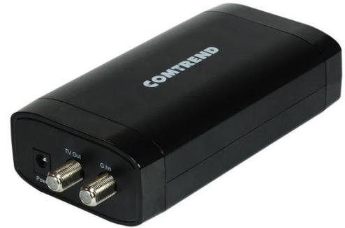
GCA-6010 está diseñado como un CPE (equipos en las instalaciones del cliente) adaptador Ethernet sobre redes domésticas de red coaxial, y también desempeñar la función de MDU sobre una red coaxial compartida. GCA-6010 cumple con los estándares ITU-T G.hn para una interfaz coaxial y admite una banda de operación de 200MHz y un diplexor incorporado para la coexistencia de servicios CATV / UHF / VHF.
